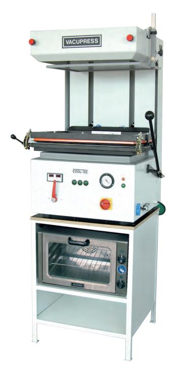
Das Tiefziehgerät formt alle thermoplastischen Materialien rationell. Es ist durch das Einhebel-Spannsystem schnell und praktisch in der Handhabung. Die Vakuumautomatik, durch Schließen des Zentralverschlusses schaltet die Pumpe selbsttätig ein bis zum Erreichen des Nennunterdruckes, und die elektronisch gesteuerte Flächenheizung bietet weitere Vorteile.
