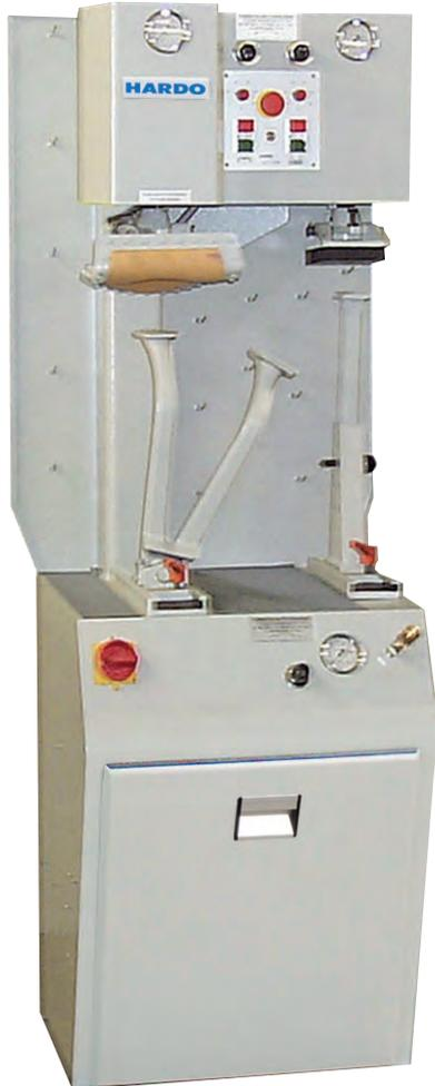
HARDO Schnellpressen zeichnen sich durch rationelle und sichere Handhabung aus. Die Sohlen- und Absatzpressen sind mit einer Zeitsteuerung ausgestattet. Die HARDO-Tronic Sicherheitsschaltung (patentiert) und der zentrale Not-Taster sorgen für Unfallschutz beim Pressen. Der schwenkbare V-Druckarm ermöglicht ein praktisches und schnelles Wechseln der Schuhe. HARDO Schnellpressen sind aus solider Stahlblechkonstruktion und mit einer vollautomatischen Kompressoranlage ausgestattet.
